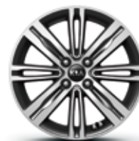
Leichtmetallfelge 16 Zoll mit 195/45 R16 Bereifung
