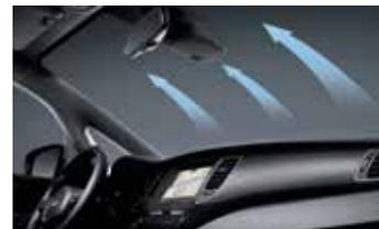
**Automatische Antischiebenbeschlagfunktion** Sollte die Windschutzscheibe einmal beschlagen sein, wird dies automatisch von einem Sensor erkannt welcher durch Aktivierung des Gebläses Gegenmaßnahmen einleitet.
