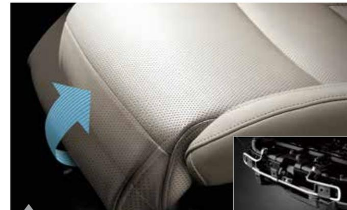
**Elektrisch verstellbare Oberschenkelauflage** Für zusätzlichen Komfort bei längeren Strecken kann die ausstattungsabhängige Oberschenkelauflage elektrisch verstellt werden.
