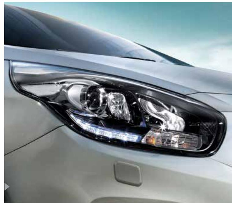
Eine verbesserte Straßenausleuchtung, mehr Sicherheit und tolle Optik: Dank Xenonscheinwerfern sowie LED Tagfahrlicht
