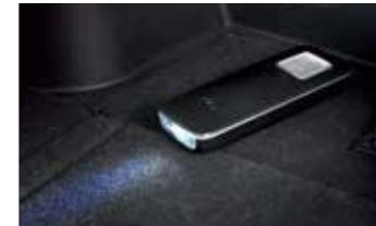
**Tragbare Taschenlampe** Die im Seitenbereich des Kofferraums montierte Lampe lässt sich ganz einfach entnehmen und als handliche Taschenlampe verwenden. Sie dient auch als Innenraumbeleuchtung des Kofferraums.
