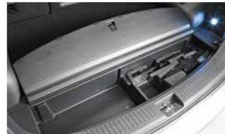
**Staufach für Laderaumabdeckung** Bei Nichtverwendung können Sie in diesem Fach bequem die Kofferraumabdeckung verstauen.
