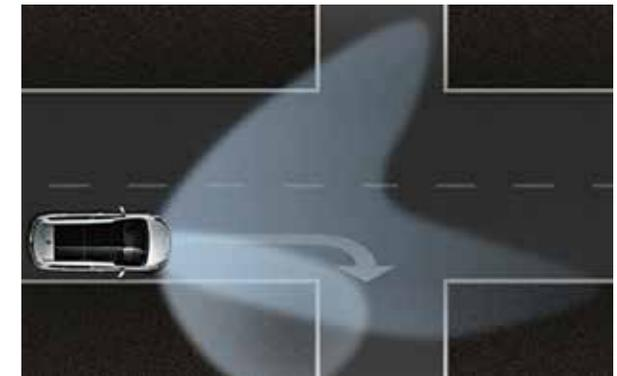
**Statisches Kurvenlicht** Abhängig vom Lenkeinschlag schaltet sich ein zusätzliches Licht ein, um Kurven bei Nacht besser auszuleuchten.
