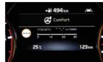
**Flexible Servolenkung** Passen Sie das Lenkverhalten Ihrem Fahrstil an: Wählen Sie zwischen dem städtischen Komfort-Modus, dem Normal-Modus oder dem Sport-Modus.
