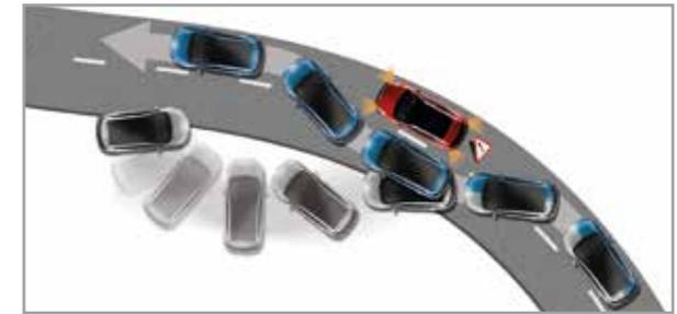
**ESC - Elektronische Stabilitätskontrolle** Wenn Sie plötzlich bremsen müssen, übt das ESC-System den richtigen Bremsdruck auf jedes einzelne Rad aus. Es steuert auch die Motorleistung, um Ihnen zu helfen, die Kontrolle zu behalten und Ihren Kia Carens wieder auf Kurs zu bringen.
