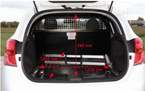
Schienensystem zur Transportsicherung sowie Trenngitter
