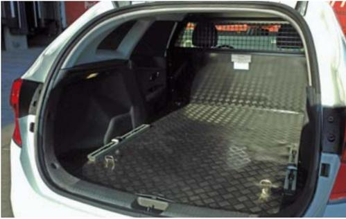
Ebener Laderaumboden mit Gummibodenbelag und Trennwand\*
