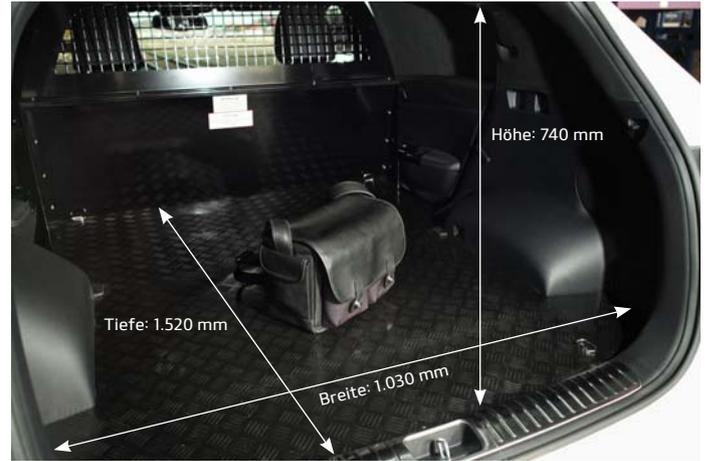
Ebener Laderaum mit Gummiboden und Trennwand sowie Trenngitter \*
