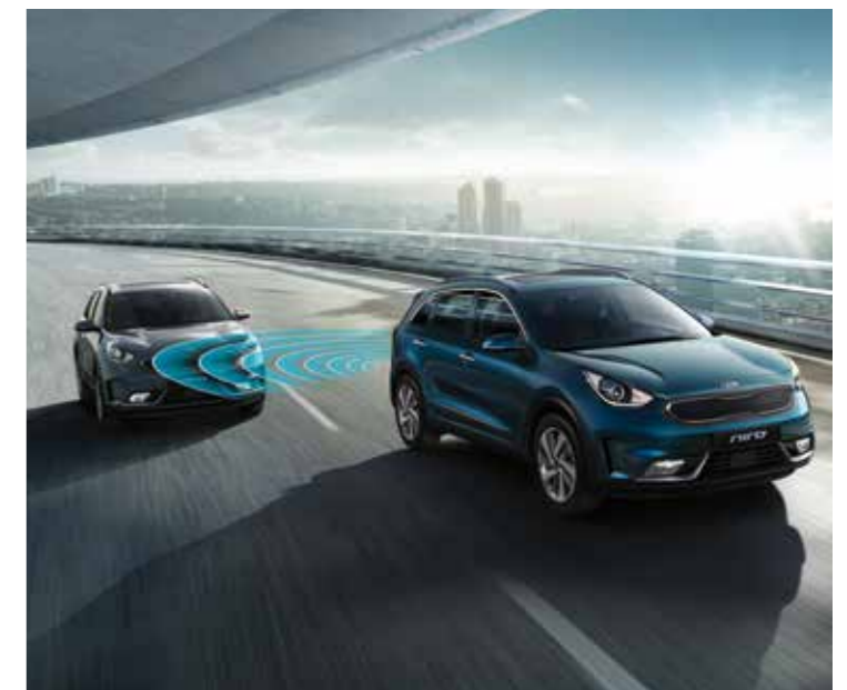
BLIS - Totwinkelassistent Die Toter-Winkel-Erkennung überwacht mithilfe von Sensoren die Seiten und die Rückseite des Fahrzeugs und informiert Sie mittels optischer Warnhinweise über Fahrzeuge im toten Winkel, um den Spurwechsel einfacher und sicherer zu gestalten.
