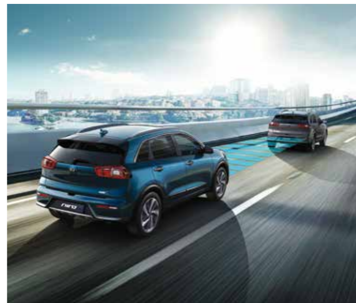
ACC - Adaptiver Tempomat Ein Radarsensor hinter dem Kühlergrill misst den Abstand zum vorausfahrenden Fahrzeug und hält automatisch eine sichere Distanz, indem er das Tempo entsprechend der Vorgabe des Fahrers regelt, auch wenn dieser weder beschleunigt noch bremst.
