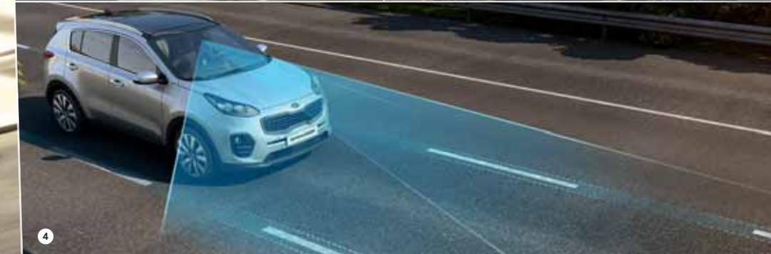
1. Das autonome **Notbremssystem (AEB)** kann sowohl vorausfahrende Fahrzeuge als auch die Straße überquerende Fußgänger erkennen. Mittels Sensoren und einer Kamera werden Abstand und Geschwindigkeit des vorausfahrenden Fahrzeugs überwacht, und der Fahrer wird bei einer potenziellen Kollisionsgefahr gewarnt. Zeigt der Fahrer daraufhin keine Reaktion, bremst das Fahrzeug automatisch ab, um den Unfall zu verhindern oder den Aufprall abzuschwächen.
