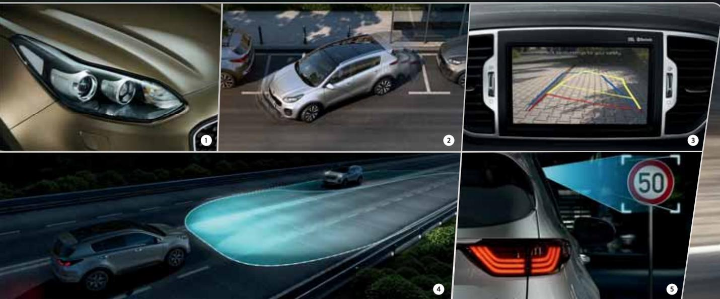
1. **Bi-Xenon-Scheinwerfer mit dynamischem Kurvenlicht** erleuchten die vor Ihnen liegende Straße bestmöglich. Das auf die Lenkung reagierende System stellt sicher, dass besonders jener Bereich der Strecke gut ausgeleuchtet ist, auf dem Sie auch tatsächlich unterwegs sind.
