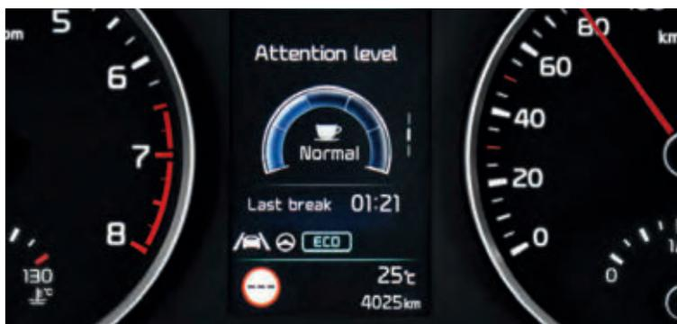
**Aufmerksamkeitsassistent.** Das System erkennt Konzentrationsverluste während der Fahrt, indem es das Fahrzeug und dein Fahrverhalten überwacht. Wenn es Zeit wird, eine Pause einzulegen, gibt der Aufmerksamkeitsassistent eine akustische Warnung aus und zeigt ein Warnsymbol in der Instrumenteneinheit an.
