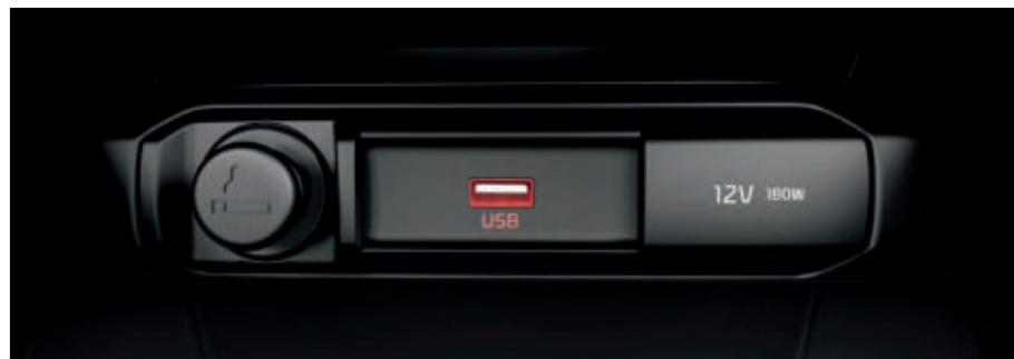
**USB-Ladeanschluss, vorne.** Über einen USB-Ladeanschluss kannst du Mobiltelefone und andere kompatible Geräte aufladen.
