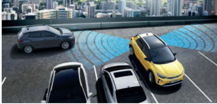
**Querverkehrsassistent & aktiver Querverkehrsassistent.** Sicher rückwärts ausparken - beim Ausparken aus Längsparklücken warnt das radarbasierte System vor potenziellem Verkehr, welcher deinen Weg kreuzt. Sobald eine Gefahr erkannt wird, warnen audio-visuelle Hinweise davor und der aktive Querverkehrsassistent bremst automatisch im Notfall das Fahrzeug.
