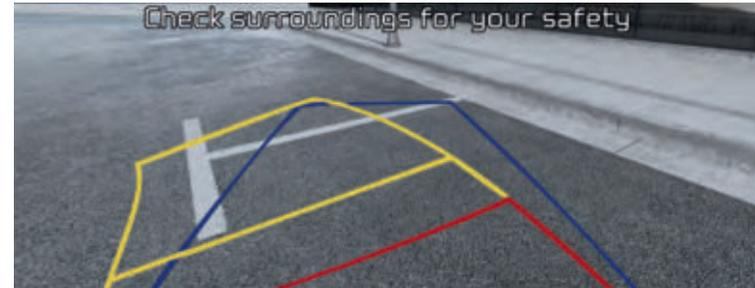
**Rückfahrkamera mit dynamischen Führungslinien.** Die Rückfahrkamera blendet dynamische, gekrümmte Leitlinien in das Bild auf dem 7-Zoll-Display ein, um dir den Weg zu weisen.
