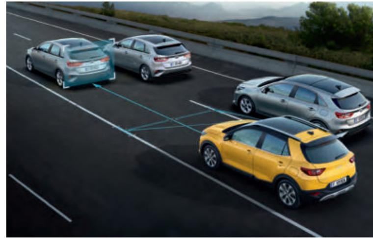
**Spurhalteassistent.** Solltest du die Spur ungewollt verlassen, warnt der Spurhalteassistent und steuert sogar in die ursprüngliche Fahrspur zurück.
