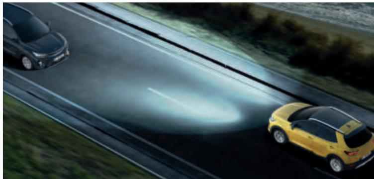
**Fernlichtassistent.** Erkennt die Kamera an der Windschutzscheibe die Scheinwerfer eines entgegenkommenden Fahrzeugs bei Dunkelheit, schaltet der Fernlichtassistent automatisch auf Abblendlicht. Sobald das Fahrzeug vorbeigefahren ist, schaltet sich das Fernlicht wieder ein.
