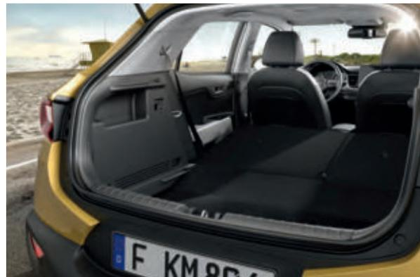
**Zweistufiger Gepäckraumboden.** Der Boden des Gepäckraums kann erhöht werden, sodass er mit den umgeklappten Sitzlehnen bündig ist (links), oder abgesenkt werden, um hohe Gegenstände zu verstauen (rechts).
