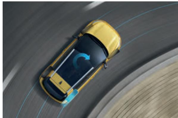
**Bremskraftverteilung.** Dieses System wurde entwickelt, um dir zu helfen, beim Abbiegen auf der Strecke zu bleiben. Beim Bremsen in Kurven wird eine asymmetrische Bremskraft auf die einzelnen Räder ausgeübt, um einem möglichen Traktionsverlust entgegenzuwirken und die Sicherheit zu erhöhen.
