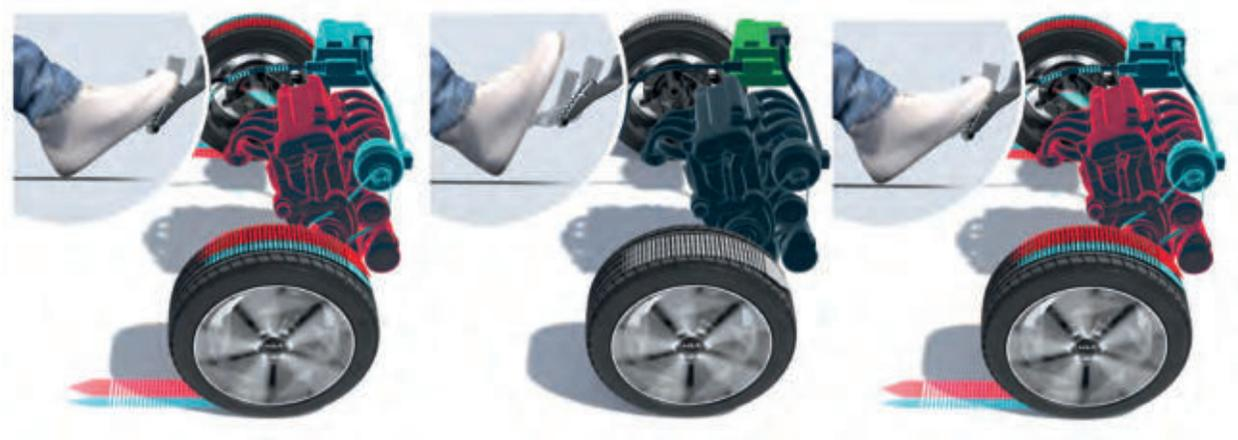
**Ausrollmodus.** Wenn der Fahrer den Fuß vom Gas nimmt und das Auto ohne Beschleunigung im Leerlauf laufen lässt, schaltet sich der Motor reibungslos ab, was zu einer effizienteren Fahrt führt. Sobald das Gaspedal gedrückt wird, übernimmt sofort der Motor. Die Ausrollfunktion und die bei ausgeschaltetem Motor zurückgelegte Strecke hängen von den Fahrbedingungen und der Fahrzeuggeschwindigkeit ab.
