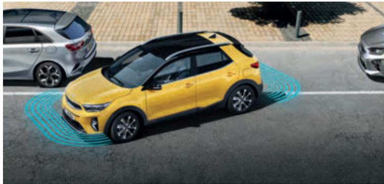
**Parksensoren vorne und hinten mit einer Ein-/ Ausschalttaste.** Ideal für sicheres Einparken. Mit Hilfe von Ultraschallsensoren an den vorderen und hinteren Stoßfängern wirst du beim Manövrieren auf einen Parkplatz vor Hindernissen gewarnt. Die akustischen Signale können ein- oder ausgeschaltet werden.
