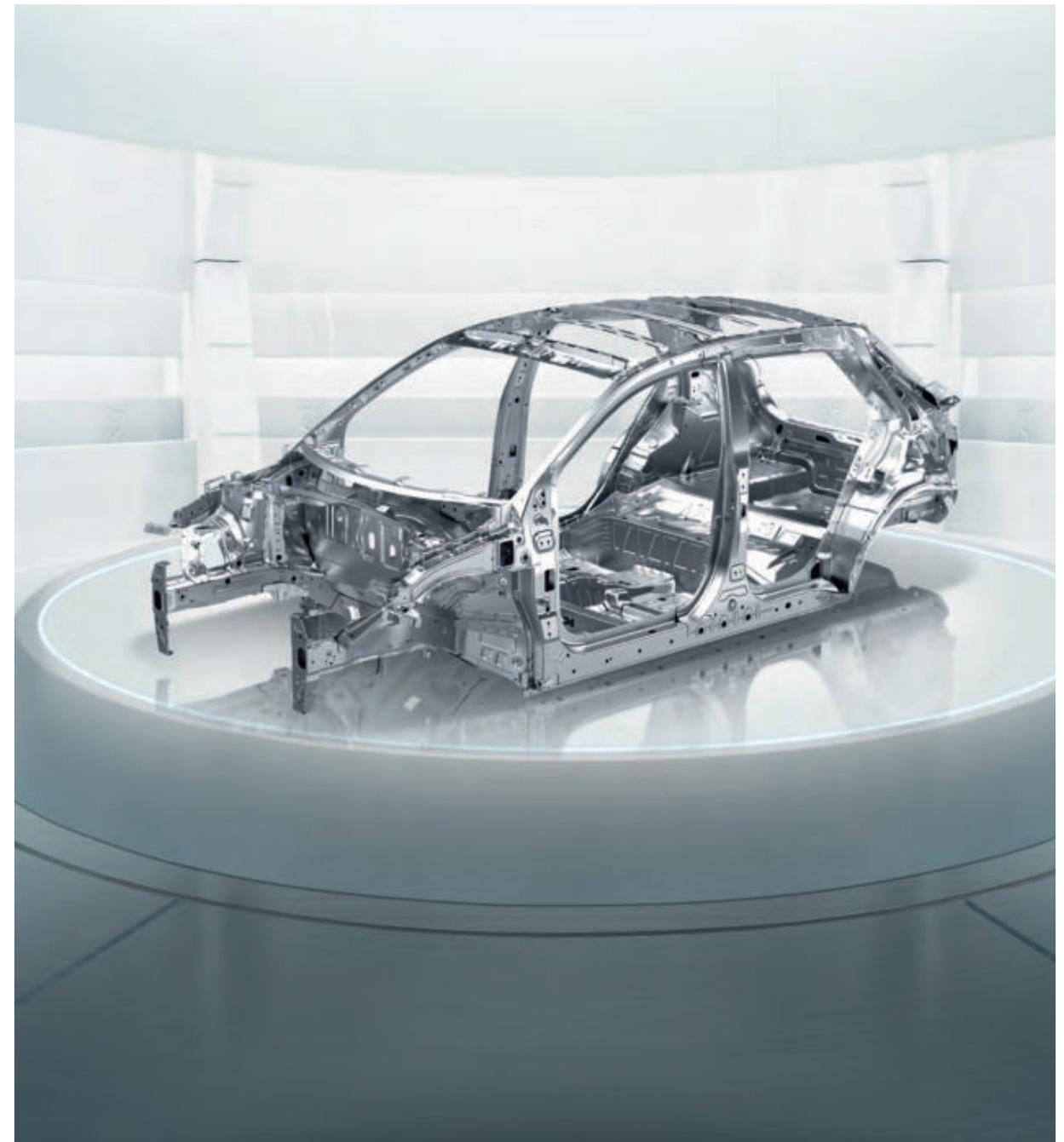
**AHSS Mehrphasenstahl für mehr Festigkeit und Schutz der Fahrgastzelle.** Beim Kia Stonic wird Mehrphasenstahl (AHSS) verwendet, um eine größere Zugfestigkeit zu erzielen, die der Karosserie eine höhere Steifigkeit verleiht und so den Fahrgastzellenschutz und zugleich die dynamische Leistung verbessert.
