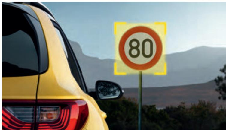
**Intelligentes Tempolimitinformationssystem.** Mithilfe einer Kamera informiert das Tempolimitinformationssystem stets über geltende Geschwindigkeitsbegrenzungen und zeigt Geschwindigkeitstafeln und Überholverbotstafeln an. Diese Informationen werden übersichtlich am Navigationsbildschirm und am Supervision Cluster angezeigt.
