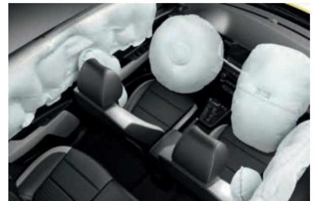
**6 Airbags.** Zu den Schutzfunktionen gehören die Front-Airbags für Fahrer und Beifahrer, zwei Airbags an den Seiten sowie zwei Vorhang-Airbags entlang der Fahrgastzelle.
