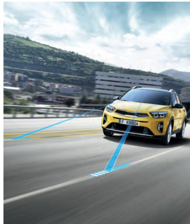
**Spurhalteassistent.** Der Spurhalteassistent unterstützt, indem er vor dem versehentlichen Verlassen deiner Spur warnt - mit einem geringen Lenkimpuls animiert er dich sogar dazu, wieder zurück in die richtige Spur zu lenken, damit du immer genau an der richtigen Stelle bist.
