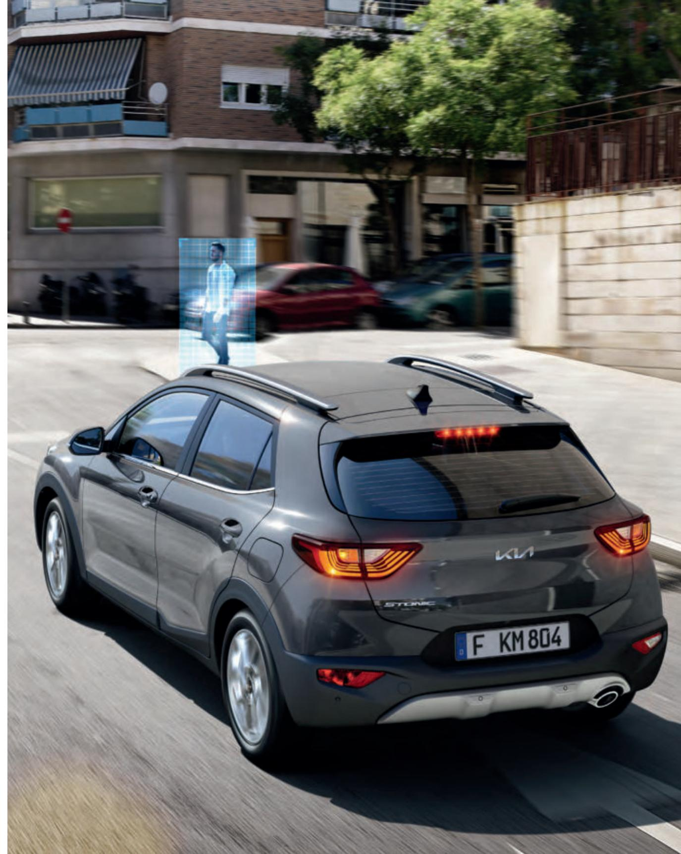
**Autonomes Notbremssystem inkl. Fußgängererkennung.** Durch die Kombination von Radar- und Kameradaten aktiviert dieses System die Bremsen, wenn es ein plötzliches Abbremsen eines vorausfahrenden Fahrzeugs erkennt, und kann das Fahrzeug bei einer Geschwindigkeit von bis zu 60 km/h vollständig stoppen. Wird ein Fußgänger vor dem Fahrzeug erkannt, wirst du gewarnt. Falls du nicht reagierst, bremst der Kia Stonic für dich, um einen Aufprall zu verhindern oder abzuschwächen.
