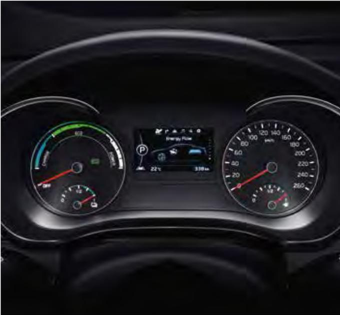
Supervision Cluster mit 4,3" TFT LCD Farbdisplay und Plug-In Hybridanzeige
