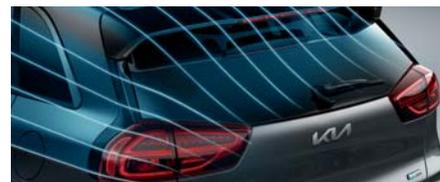
**Heckspoiler.** Oberhalb des Heckfensters nutzt ein Spoiler den Luftstrom zur Stabilisierung der Karosserie bei schnelleren Fahrten.
