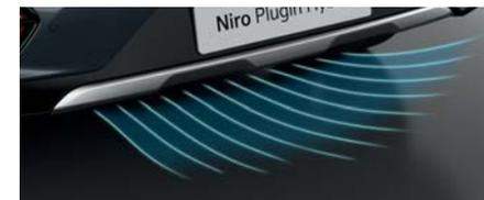
**Heck-Diffuser.** Um Stabilität und aerodynamische Kontrolle zu erzielen, ist unterhalb des Hecks des Kia Niro eine Spoilerplatte mit Längsnuten angebracht.
