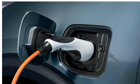
**Ladestecker.** Lade deinen Kia Niro Plug-In Hybrid ganz einfach zu Hause mittels herkömmlicher 230 Volt-Steckdose oder an einer öffentlichen Ladestation auf. Die Ladedauer an einer öffentlichen Ladestation (max. 3,3 kW über Typ 2 Ladekabel) dauert etwa 2 h 15 min.
