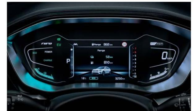
**7" TFT LCD Supervision Cluster.** Eine ansprechende, durchdachte, individuell anpassbare Instrumenteneinheit liefert Temperaturdaten, Reifendruckwarnungen, aber auch andere essenzielle Fahrzeug- und Fahrtinformationen. Zudem zeigt es den Status des Hybrid- Ladesystems einschließlich Kraftstofffüllstand, Batterieladestand und Energienutzung an. Auf dem hochauflösenden Display lassen sich zahlreiche Informationen auf einen Blick ablesen.
