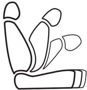
**8-fach elektrisch verstellbarer Fahrersitz.** Um das Fahren so komfortabel und angenehm wie möglich zu gestalten, lässt sich der Fahrersitz in acht Richtungen motorisch verstellen: vertikale, horizontale Position, Neigung und Lendenwirbelstütze.
