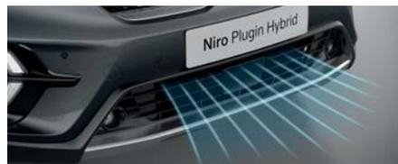
**Aktive Luftklappe.** Eine aktive Luftklappe hinter dem Kühlergrill kühlt den Motor. Sie schließt sich bei höherer Geschwindigkeit, um einen geringeren Luftwiderstand, höhere Leistung und geringeren Kraftstoffverbrauch zu ermöglichen.
