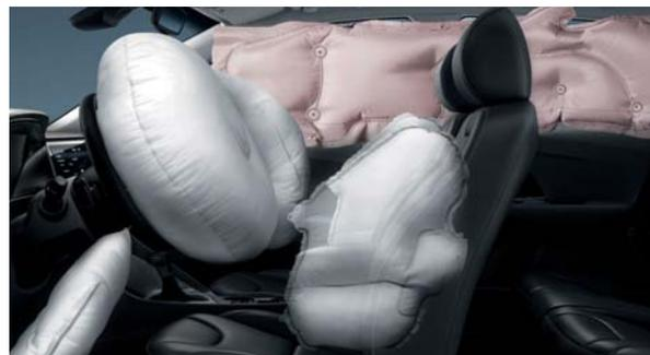
**7 Airbags.** Um die Insassen bei einem Aufprall zu schützen und das Verletzungsrisiko zu mindern, verfügt der Niro serienmäßig über einen Fahrer- und einen Beifahrer-Airbag, zwei Seitenairbags vorne, zwei seitliche Curtain-Airbags sowie über einen Knieairbag für den Fahrer.
