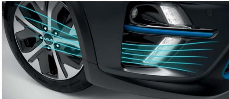
**Luftschleier.** Ein Luftschleier erzeugt vorne einen beschleunigten Luftstrom und reduziert den durch turbulente Luft verursachten Luftwiderstand für eine verbesserte Aerodynamik.
