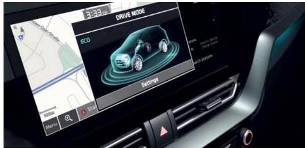
**Drive Mode Select.** Der e-Niro lässt sich an deinen individuellen Fahrstil anpassen. Dies beginnt bei dem besonders effizienten ECO+ Modus und führt über ECO und NORMAL zum sehr dynamischen SPORT Modus. Diese vier Fahrmodi erlauben dir die Leistung und den Energieverbrauch deines Fahrzeugs zu kontrollieren.
