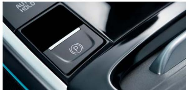
**Elektrische Parkbremse inkl. Auto-Hold-Funktion.** Adieu unbequeme Handbremse. Ab jetzt musst du nur noch eine Taste betätigen, um die Parkbremse zu aktivieren.
