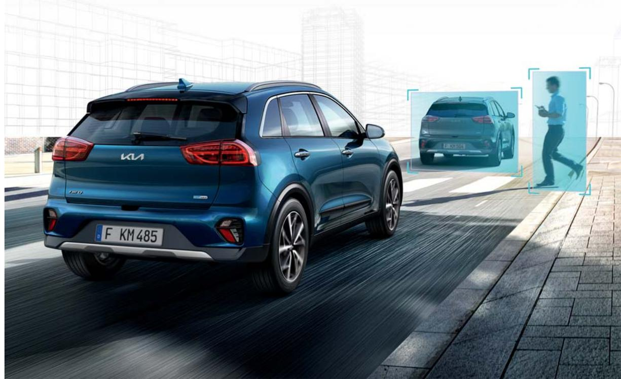
**Autonomes Notbremssystem inkl. Fußgängererkennung.** Durch die Auswertung von Kamera- und Radardaten kann das autonome Notbremssystem potenzielle Kollisionen mit einem Fahrzeug, Fußgänger oder sonstigem Hindernis erkennen, davor warnen und sogar maximale Bremskraft anwenden, um das Fahrzeug zu stoppen oder Schäden zu minimieren.
