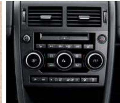
Zierleisten an der Mittelkonsole aus gebürstetem Aluminium in Dark Grey
