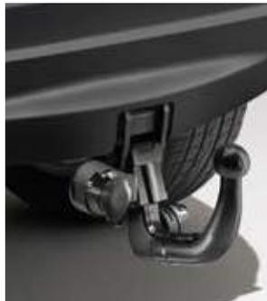
**Anhängesystem - Abnehmbare Anhängerkupplung<sup>5</sup>**
