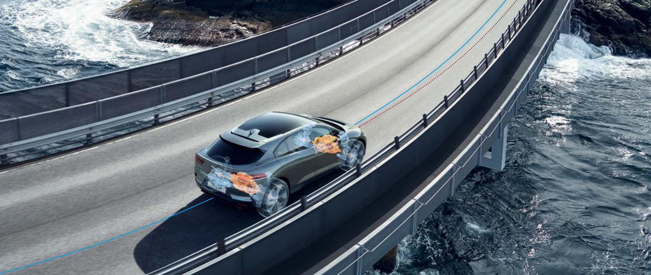
Torque Vectoring by Braking (TVBB) bremst das kurveninnere Vorder- und Hinterrad kontrolliert und unabhängig voneinander ab und wirkt so einem Untersteuern entgegen. Dadurch bleiben Sie immer in der richtigen Fahrspur.
