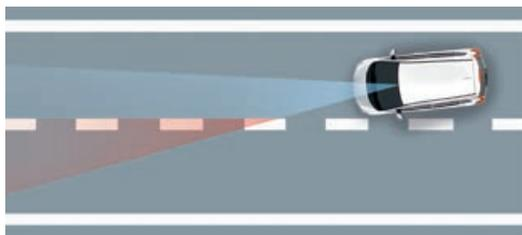
Wenn Fahrbahnmarkierungen erfasst werden und das Fahrzeug ohne Betätigen des Blinkers die Spur verlässt, weist der Spurhaltewarner mithilfe von akustischen und optischen Warnmeldungen darauf hin.
