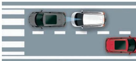
**3:** Sollten Sie darauf nicht reagieren und eine Kollision kurz bevorstehen, leitet der City-Notbremsassistent automatisch eine Notbremsung ein, um die Geschwindigkeit so weit wie möglich zu verringern. Unter guten Fahrbedingungen kann eine Kollision sogar vollständig verhindert werden.
