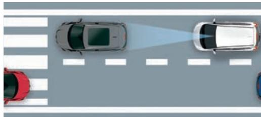
**1:** Wenn Sie mit einer Geschwindigkeit zwischen 5 und 30 km/h durch die Stadt fahren, überwacht das System die Entfernung zwischen Ihnen und dem vor Ihnen fahrenden Auto, um das Risiko einer Kollision so weit wie möglich zu senken.
