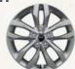
TITAN - Leichtmetallfelgen 16 Zoll mit 215/70 R16 Bereifung
