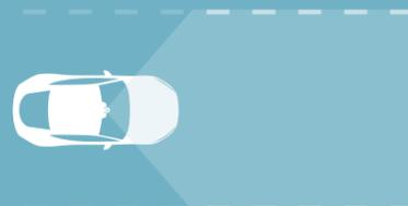
**Der Spurhalteassistent** registriert ein unbeabsichtigtes Verlassen der Fahrspur und unterstützt Sie durch sanfte Lenkimpulse dabei, das Fahrzeug zurückzulenken.
