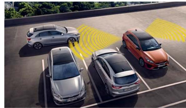
**Aktiver Querverkehrsassistent\*.** Der radarbasierte Querverkehrsassistent (hinten) warnt dich beim parallelen Einparken oder Rückwärtsausparken aus einer Einfahrt vor entgegenkommendem Verkehr, der deinen Weg kreuzt, und bremst bei Bedarf, um eine Kollision zu vermeiden.
