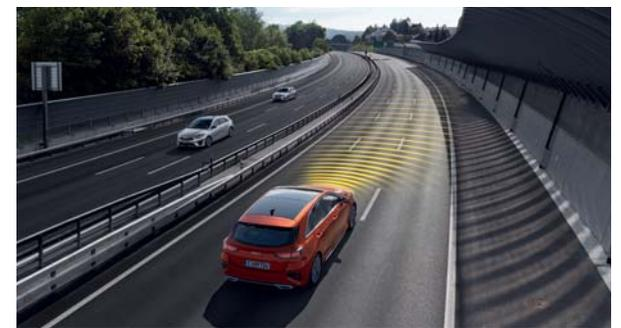
**Navigationsgestützter Tempomat für Kurven.** In Kombination mit dem Autobahnassistenten nutzt die Kurvenfunktion Daten aus dem Navigationssystem, um Kurven im Straßenverlauf zu erkennen, die Fahrgeschwindigkeit zu reduzieren und nach der Kurve, wenn es die Umstände erlauben, wieder auf die voreingestellte Geschwindigkeit zu beschleunigen.
