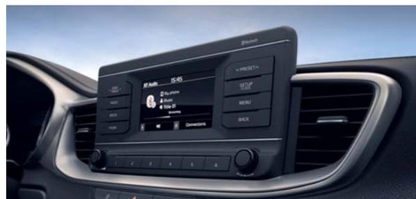
**5" Multimedia-Display.** Das 5-Zoll-Soundsystem mit RDS und DAB ist mit einem Mono-TFT-LCD-Bildschirm ausgestattet. Zusätzlich zum Radio kann das System über den USB-Anschluss mit anderen mobilen Endgeräten wie einem Smartphone verbunden werden. Zudem ist eine drahtlose Audioübertragung mittels Bluetooth möglich.
