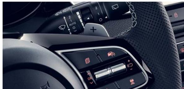
**Schaltwippen.** Mit den Schaltwippen kannst du schnell in einen anderen Gang schalten, ohne die Hände vom Lenkrad zu nehmen. Außerdem machen sie das Fahren dynamischer und intuitiver, während du die volle Kontrolle behältst.
