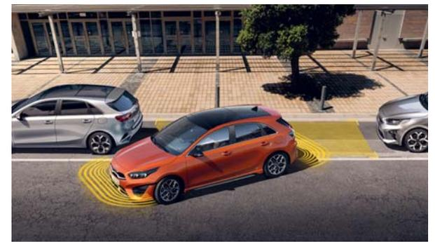
**Smart Parking Assist System.** Das Smart Parking Assist System macht das Parken zum Kinderspiel. Es nutzt Front-, Seiten- und Rücksensoren, um dich beim parallelen, schrägen und senkrechten Einparken zu unterstützen. Alles, was du tun musst, ist die Bremse, das Gaspedal und die Gangschaltung zu bedienen. Das System übernimmt das Lenken. Es kann dir sogar helfen, aus Längsparklücken auszuparken
