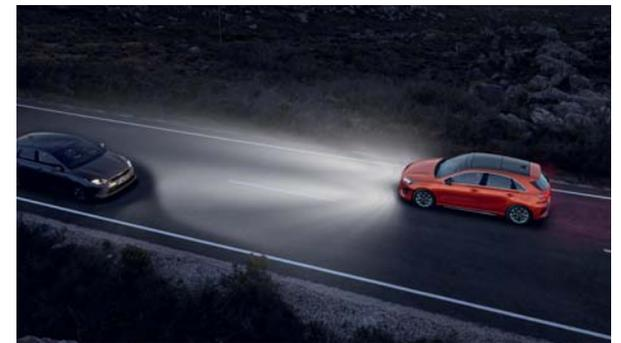
**Fernlichtassistent.** Erkennt die Kamera an der Windschutzscheibe bei Dunkelheit die Scheinwerfer eines entgegenkommenden Fahrzeugs, schaltet der Fernlichtassistent automatisch auf Abblendlicht, um andere Fahrer nicht zu blenden. Sobald das Fahrzeug vorbeigefahren ist, schaltet sich das Fernlicht automatisch wieder ein.
