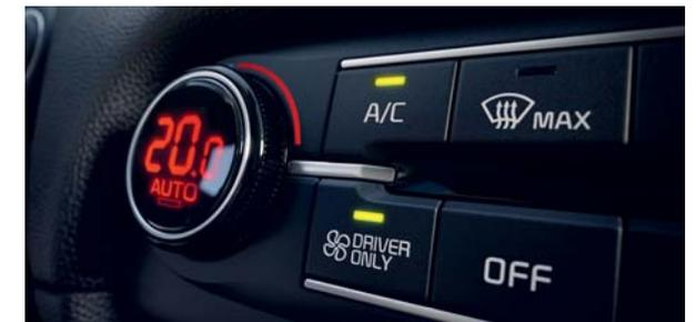
**Taste „Nur Fahrer“.** Taste „Nur Fahrer“. Diese Taste aktiviert die Klimaanlage nur für den Fahrer. Durch die Auswahl einzelner Zonen kann die Klimaanlage nur auf den Fahrer ausgerichtet werden, was den Energieverbrauch für unbesetzte Bereiche im Fahrzeug reduziert und die Reichweite deines Kia erhöht.
