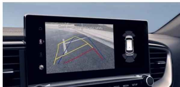
**Rückfahrkamera.** Die Rückfahrkamera mit verbesserter Funktionalität erhöht deine Sicherheit, wenn du rückwärts einparkst. Das neue Modell ermöglicht es zwischen verschiedenen Kameraansichten zu wechseln und zeigt dynamische Hilfslinien an, um dich an die richtige Stelle zu führen. Der Monitor kann nun auch während der Fahrt aktiviert werden, um näherkommende Fahrzeuge zu sehen.
