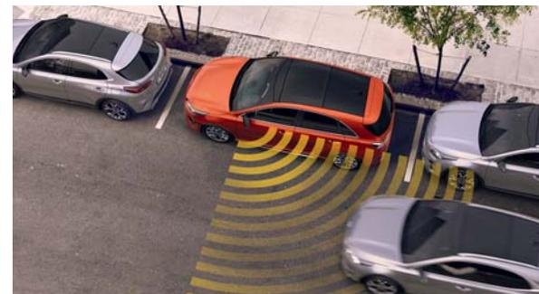
**Warnungsassistent für sicheres Aussteigen.** Um ein sicheres Aussteigen aus dem Ceed zu gewährleisten, prüft das System potenziell auf das Fahrzeug zukommende Gefahren. Wenn eine Gefahr festgestellt wurde, wird ein akustisches und visuelles Warnsignal ausgegeben.
