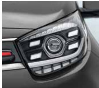
Halogen-Projektionscheinwerfer mit Bi-Funktion (für Fernlicht) und LED-Tagfahrlicht (Silber, Gold, GT-Line & X-Line)
