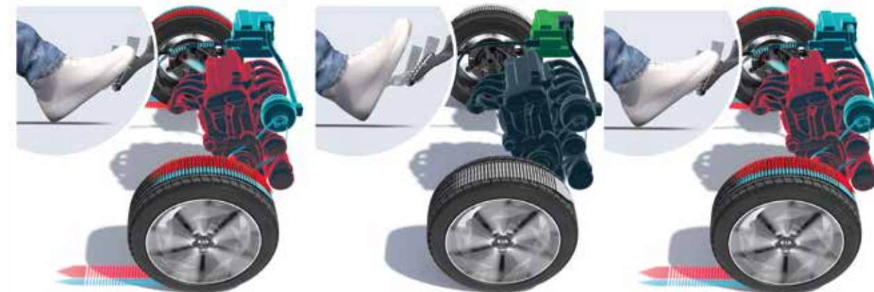
Vereinfachte visuelle Darstellung des Mild Hybrid iMT-Ausrollvorgangs
