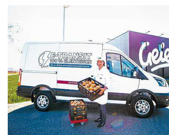
Kastenwagen, Doppelkabine, Fahrgestell, Pritsche, 3,5/ bis 4,25 t, Reichw. bis 317 km, ca. 80% Ladung in 38 Min.: der Ford E-Transit
